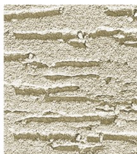
BOLIX MP R 25 szlachetna mineralna wyprawa tynkarska do nakładania ręcznego o granulacji ok. 2,5 mm (faktura kornik)
